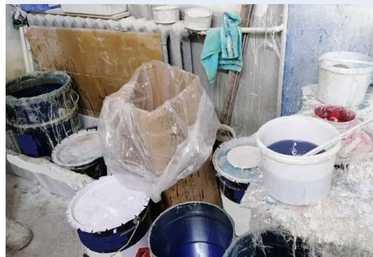
↓ Pojemniki z żywicami i klejami niezabezpieczone przed uwalnianiem się oparów do środowiska pracy
