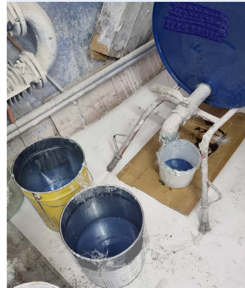
↑ Otwarte, niezabezpieczone przed parowaniem pojemniki z żywicą
